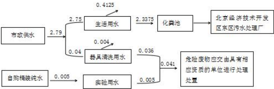
图 1 水平衡图 单位：m 3 /d
